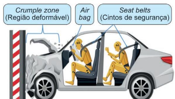
Considerando o carro, seus ocupantes e o muro da figura como um sistema isolado, o *crumple zone* aumenta a segurança dos passageiros porque, durante uma colisão, a deformação da estrutura do carro
