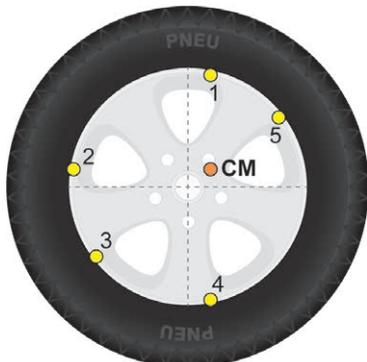
Em qual ponto deve ser fixada a peça de chumbo, a fim de corrigir a posição do centro de massa desse conjunto roda/pneu?
