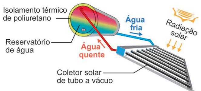
O processo pelo qual ocorre transferência de calor dos coletores solares para o reservatório térmico é a
