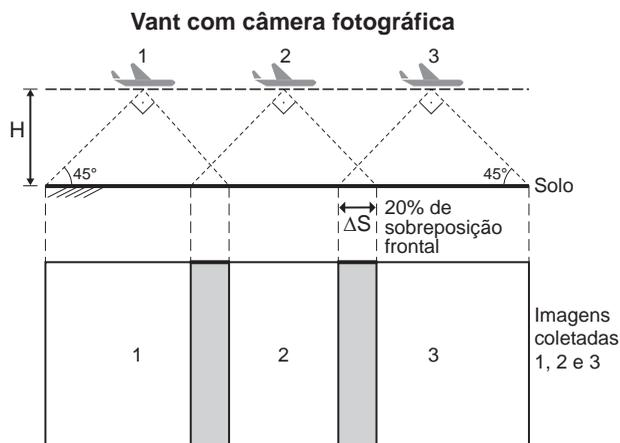
O operador do vant recebe uma encomenda na qual as imagens devem ter uma sobreposição frontal de 20% em um terreno plano. Para realizar a aquisição das imagens, seleciona uma altitude  $H$  fixa de voo de 1 000 m, a uma velocidade constante de  $50 \text{ m s}^{-1}$ . A abertura da câmera fotográfica do vant é de  $90^\circ$ . Considere  $\text{tg}(45^\circ) = 1$ .
